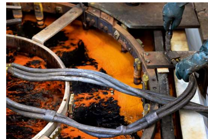
In einer Chrom-Schwefelsäure-Mischung werden Sperrhähne hart verchromt. Dies dient zum Schutz vor Verschleiß und Korrosion.
