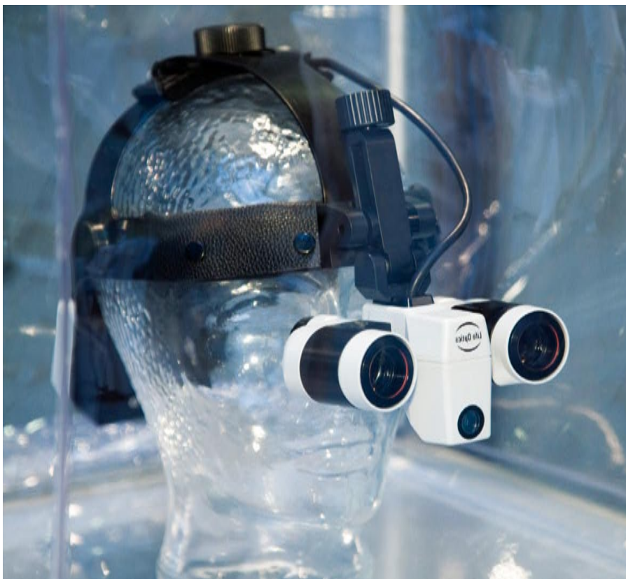
Erfunden und patentiert in Österreich: Das „Varioscope“ ist das erste Mikroskop, das man direkt am Kopf tragen kann.
